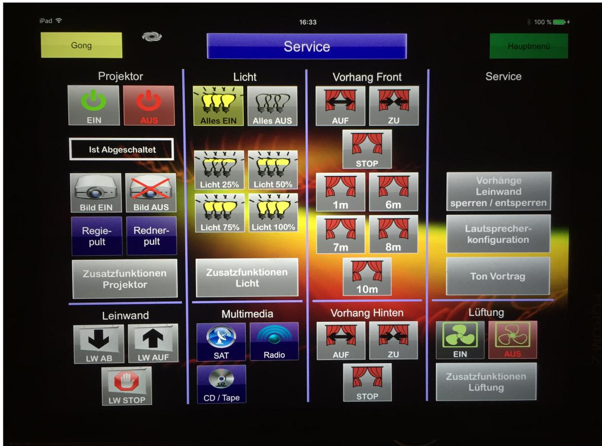
Die Hauslichtanlage sowie die Klimaanlage, Beamer inkl. Videoquellenwahl, SAT-Receiver und Radio, werden mittels einfach strukturiertem Drahtlos-Touchpanel bedient.
